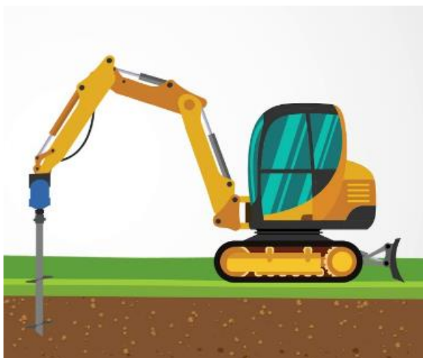
Figur 16, exempel bild på installation av markskruv med grävmaskin, samt Helical pälning med 2 kragar.
